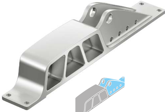
Fresado planeado, fresado lateral
