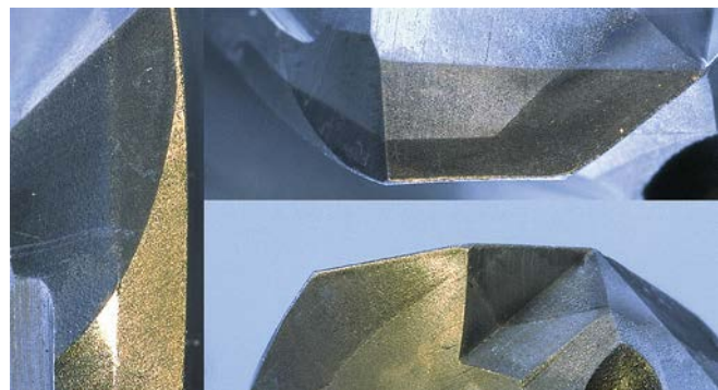
Filo en buen estado (120 agujeros mecanizados)
